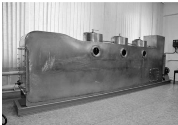
Автоматизированная система поверки (градуировки) речных гидрологических вертушек
