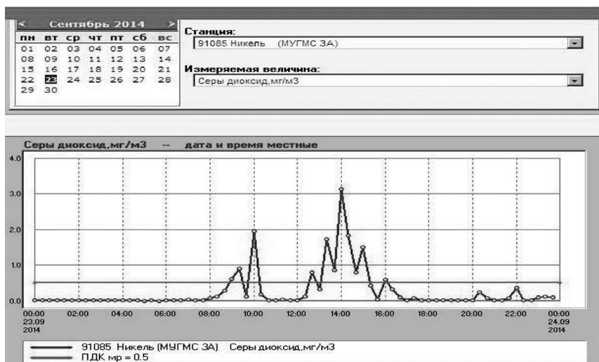
Непрерывные данные содержания диоксида серы в атмосферном воздухе п. Никеля по данным территориальной автоматизированной системы контроля над состоянием атмосферного воздуха
