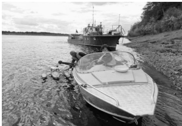
Подготовка акустического доплеровского профилографа River Ray для измерений расхода воды на ГП-1 Малая Слуда (филиал «Коми ЦГМС»)
