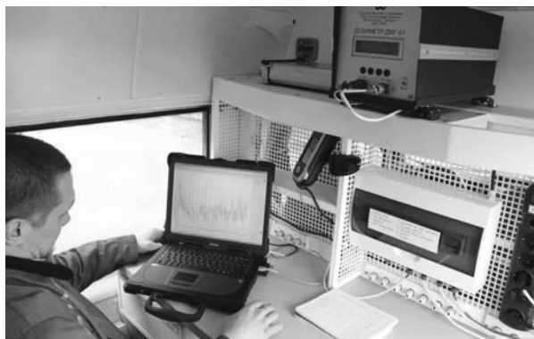
Маршрутная гамма-съемка местности по заданному маршруту на автомобильной лаборатории радиационной разведки
